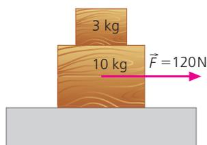
El coeficiente de rozamiento cinético entre este último bloque y el suelo es de 0,25. Si sobre el bloque de 10 kg actúa una fuerza horizontal,  $F$ , de 120 N, determina:
