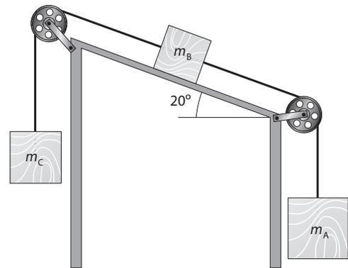
5. Determina la aceleración con que se moverá el sistema de la figura, así como las tensiones en ambas cuerdas, si  $m_A = 4 \text{ kg}$ ,  $m_B = 2 \text{ kg}$ ,  $m_C = 3 \text{ kg}$  y el coeficiente de rozamiento entre  $m_B$  y el plano vale 0,32.
