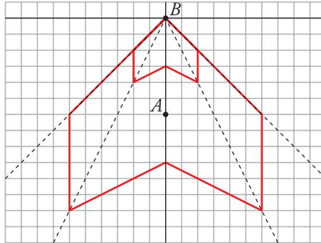
**32** ▣▣▣ Para construir un pentágono regular de 2 cm de lado, copiamos un pentágono regular cualquiera (figura roja), alargamos dos de sus lados consecutivos hasta 2 cm y completamos una figura semejante a la roja con los lados paralelos. Calca en tu cuaderno el pentágono rojo y, procediendo como arriba, dibuja un pentágono regular de 3 cm de lado.
